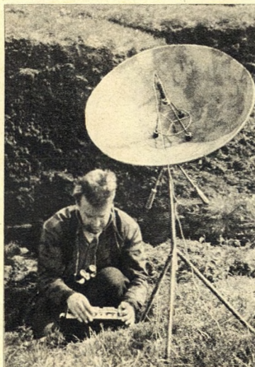
Rechts: Bild 2. Großer Parabolreflektor mit 80 cm Durchmesser
