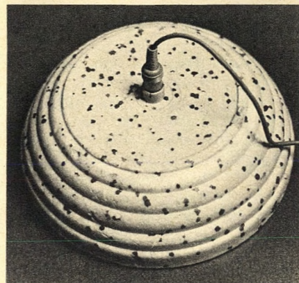
Bild 3. Sehr einfache und billige Behelfslösung, eine Blumenschale aus Schaumstoff dient als Reflektor für das Mikrofon; a = Vorderseite, b = Rückseite, die Kabelkupplung dient als Befestigung. Aufnahme: O. Limann
